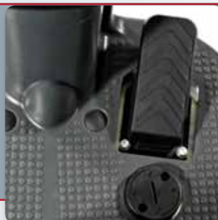
Nuovo pedale con sistema di regolazione del tallone (brevettato) per eliminare lo stress del piede destro
